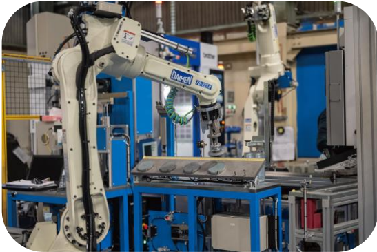
無人製造ライン（ロボット2台連動）
