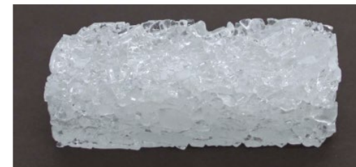
図8 粒状廃ガラスカレットのランダム充填によるガラスブロック（サイズ：縦40×横
