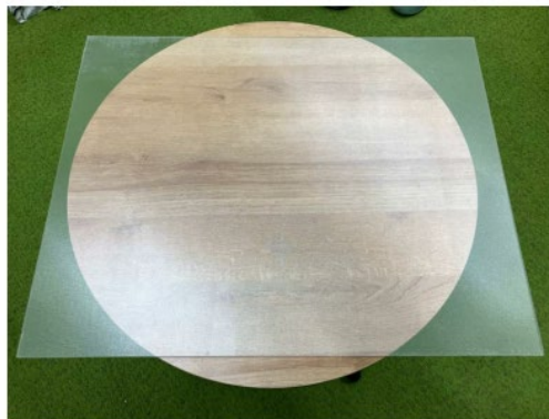
図4 リサイクル板ガラス（サイズ：縦520×横660×厚み3.2mm）120×厚み40mm
